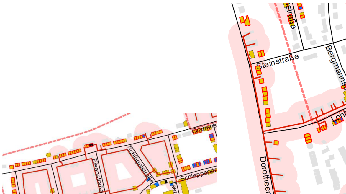
Abbildung 45: Umstellung auf Fernwärme (von Erdgas) in der Grabenstraße / Kohlenstraße und Dorotheenstraße / Lohbergstraße
